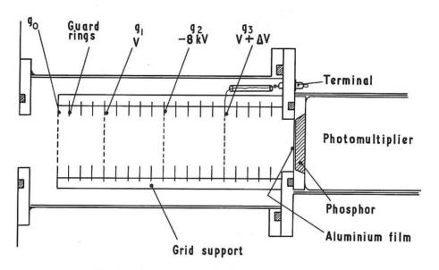
Fig. 2 Ion energy analyser. (CLM-R 49)
